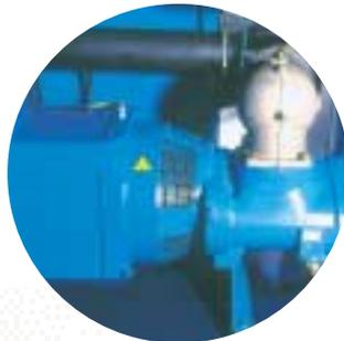
*Pérdidas de rendimiento del accionamiento inexistentes debido al acoplamiento directo entre el motor y el elemento de compresión.*
